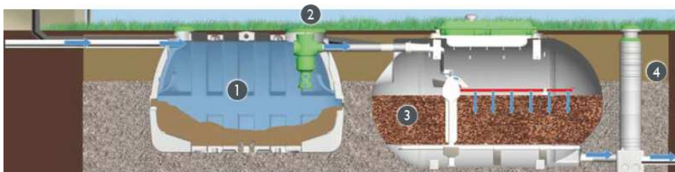
Figure 1 : Filière "Filtre à coco" STRATEPUR®
